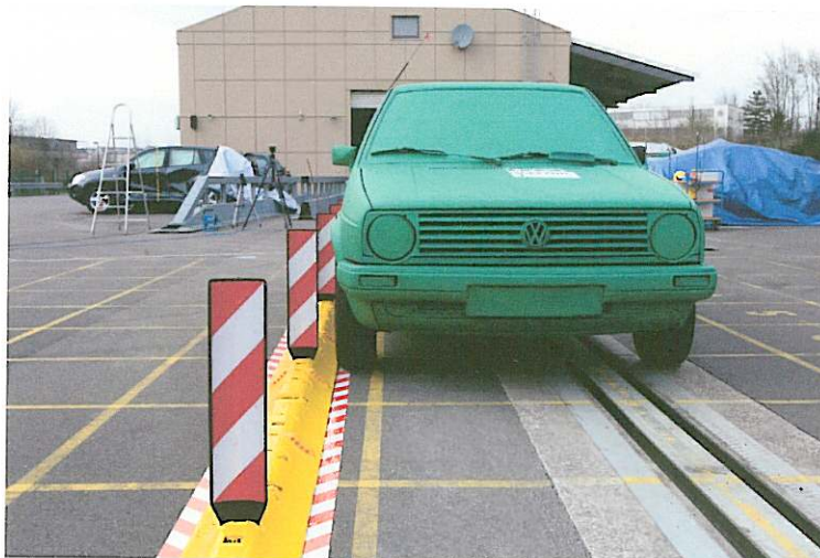
Abb. 4: Anfahrtsituation unter 1° vor der Prüfung
