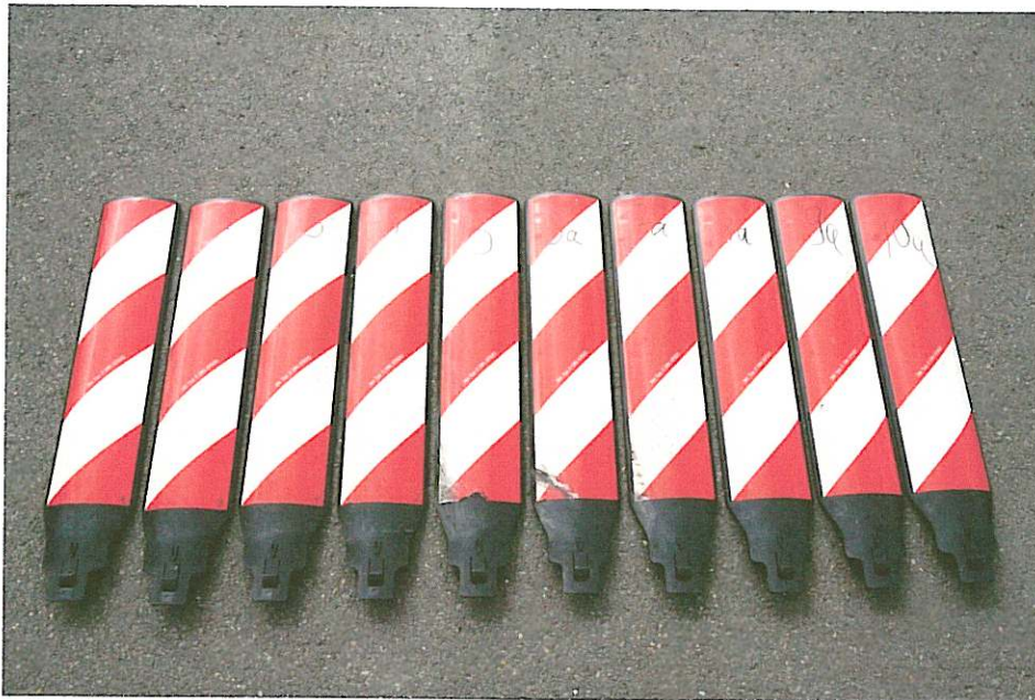
Abb. 10: Kleine Leitbaken nach Prüfung der Festigkeit bei Bremsvorgängen
